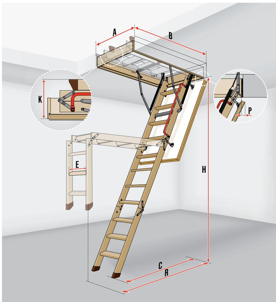
Pour commander un escalier LWK Komfort sur mesure, il faut préciser les dimensions exactes de la trémie dans le plafond (**A** et **B**), ainsi que la hauteur sous plafond (**H**).
