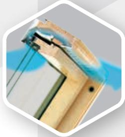
Entrée d'air réglable avec grille de ventilation, installée en partie haute dans le cadre dormant de la fenêtre. Ce système de ventilation offre en fonction de la largeur de la fenêtre un débit jusqu'à 24,7 m<sup>3</sup>/h (à 2 Pa). Pour les locaux où une ventilation normale est exigée.
