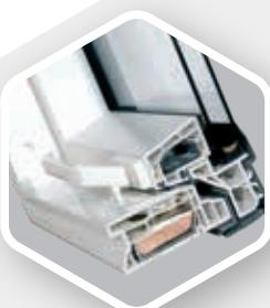
Les fenêtres les plus faciles à entretenir sont incontestablement les fenêtres en **PVC**. Les profilés extrudés à renforts métalliques, n'absorbent pas l'humidité, sont durables et sont résistants à la corrosion. Ces fenêtres sont destinées aux pièces d'eau avec un taux d'humidité constant et élevé. Les **fenêtres en PVC** sont classées dans la plus haute classe A, selon la norme NBN EN 12608, une norme de référence pour la fabrication de fenêtres en PVC.
