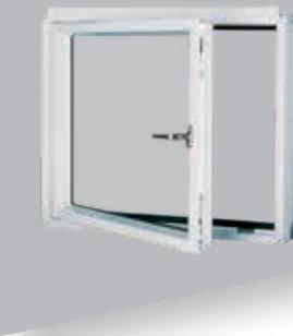
Ce modèle de fenêtre de façade fonctionne comme une fenêtre oscillo-battante traditionnelle. Le vantail s'ouvre de façon battante (à la française) ou de façon tombante. La poignée à mi-hauteur de l'ouvrant est pourvue d'une serrure à clef. Au choix, la fenêtre peut s'ouvrir par la droite (BDR) ou par la gauche (BDL, comme sur l'image).
