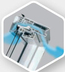
Entrée d'air réglable avec grille de ventilation, installée en partie haute dans le cadre dormant de la fenêtre. Ce système de ventilation offre en fonction de la largeur de la fenêtre un débit jusqu'à 18 m<sup>3</sup>/h (à 2 Pa). Pour les locaux où une ventilation normale est exigée.
